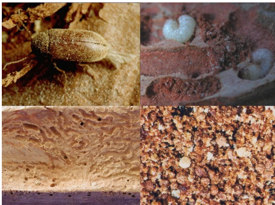
5.att. Ķirmis: Vaboles māfīte; kāpuri un to izgrauztajās ejas. – Notēsts koka fragments ar kāpuru grauzumiem aplievas daļā; koksnes milti ar apaļām ekskrementu daļiņām.
