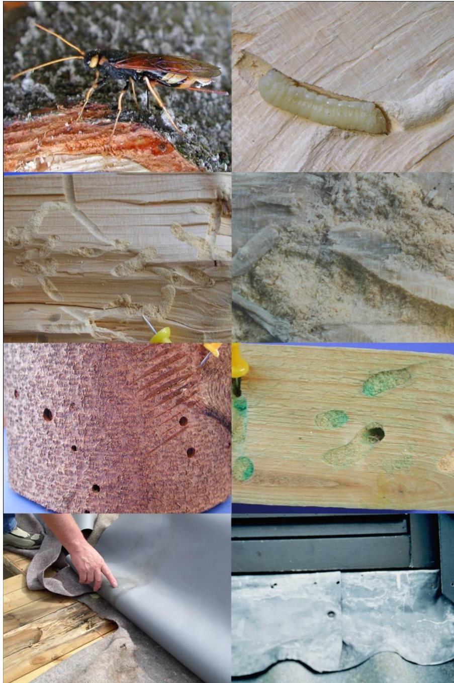
4.att. Lielā skujkoku ragaste: Māfīte olu dēšanas laikā; kāpurs. – Izgrauztās ejas dažādos virzienos, piebļīvētas ar koksnes miltiem; raksturīgs bojājums ar kāpuru izgrauztām ejām, sabļīvēti koksnes milti (detalizēti) – Mizas gabals ar izskrejas caurumiem; jumta lata ar kāpuru izgrauztām ejām; detalizēti. – Necaurļaidīga folija ar kukaiņu izskrejas caurumiem; logu skārda plāksnes ar kukaiņu izskrejas caurumiem; detalizēti.
