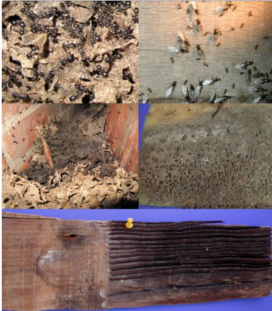
17.att. Skudras: Spīdīgā melnā skudra; skudras to ligzdā; spārnoti dzimumgatavību sasnieguši īpatņi izšķīlšanās laikā. – Iebūvēta ligzda starp ēkas mūri un koksnes konstrukcijas sastāvdaļu; skudru izbūvēta ligzda no izolējošā materiāla daļiņām. – Bojāts grīdas dēlis.
