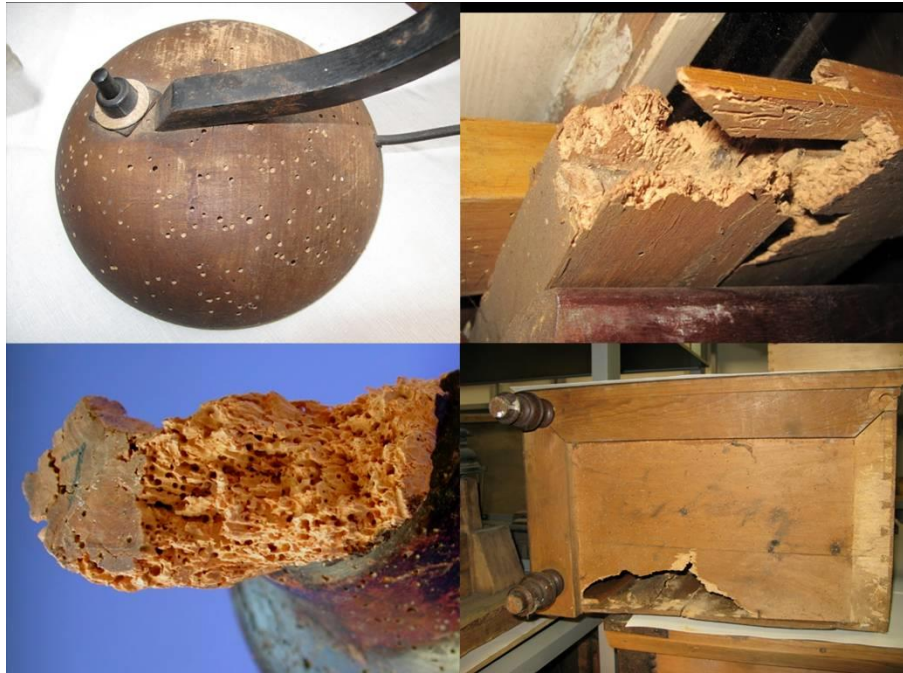
9.att. Mēbeļu ķermis, dažādi koksnes kaitēkļu bojājumi mēbelēs: Lampas pamatne (Papes Bīvdabas muzejs), salūzusi statne. – Skapja balsts (detalizēti); skapis muzeja krātuvē (Latvijas Etnogrāfiskais Bīvdabas muzejs).
