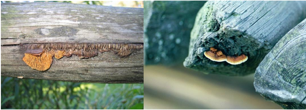
15. att. Gloeophyllum sepiarium brīvdabas muzejā uz sētas kārts; sēne atjaunotā ezerpilī uz jumta seguma.
